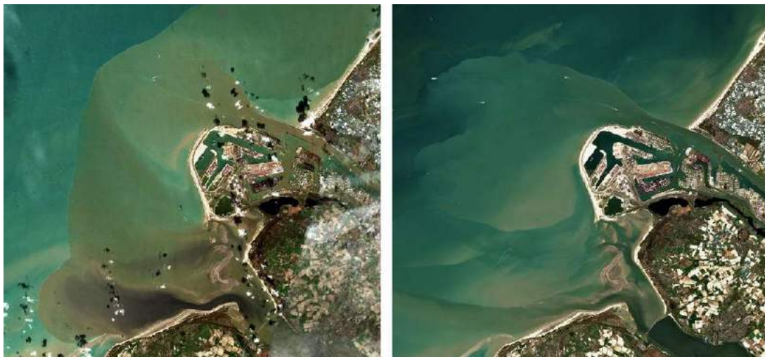
Figuur 3-54: Uitstroom van slibrijk rivierwater tijdens een periode van verhoogde rivierafvoer op links: 14/03/19 (Boven-Rijn: 5.700 m 3 /s en Maas: 1.500 m 3 /s) die gemiddeld 5 d/j optreedt en rechts twee weken later (Boven-Rijn: 2.400 m 3 /s en Maas: 350 m 3 /s) die gemiddeld 100 d/j optreedt en waarbij de Haringvlietluis weer grotendeels gesloten is.
