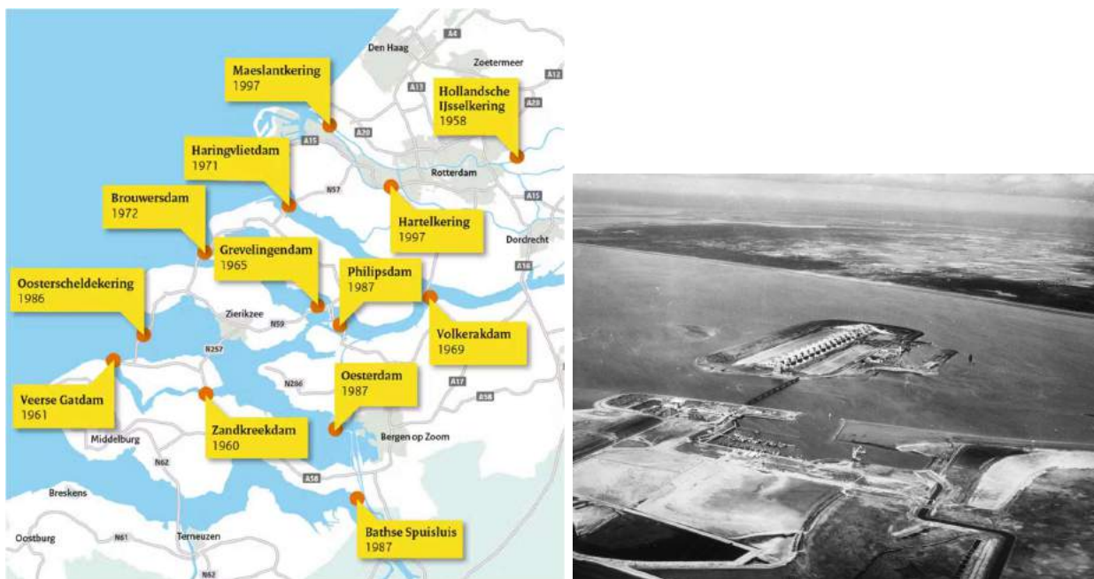
Figuur 2-32: De deltaxerken met jaar van oplevering (links) en foto van de bouw van de Haringvlietdam en sluisen (rechts). Bron: RWS
