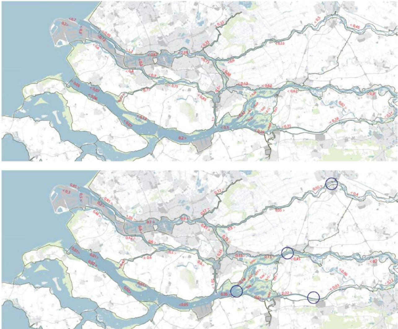
Figuur 3-12: a en b. Stroomsnelheden in m/s tijdens eb (boven) & vloed (onder) bij een gemiddelde Rijn- en Maasafvoer. Met < en > is de stroomrichting aangegeven. Bron: Rijn-Maasmond km uitvoer www.waterberichtgeving.nl
