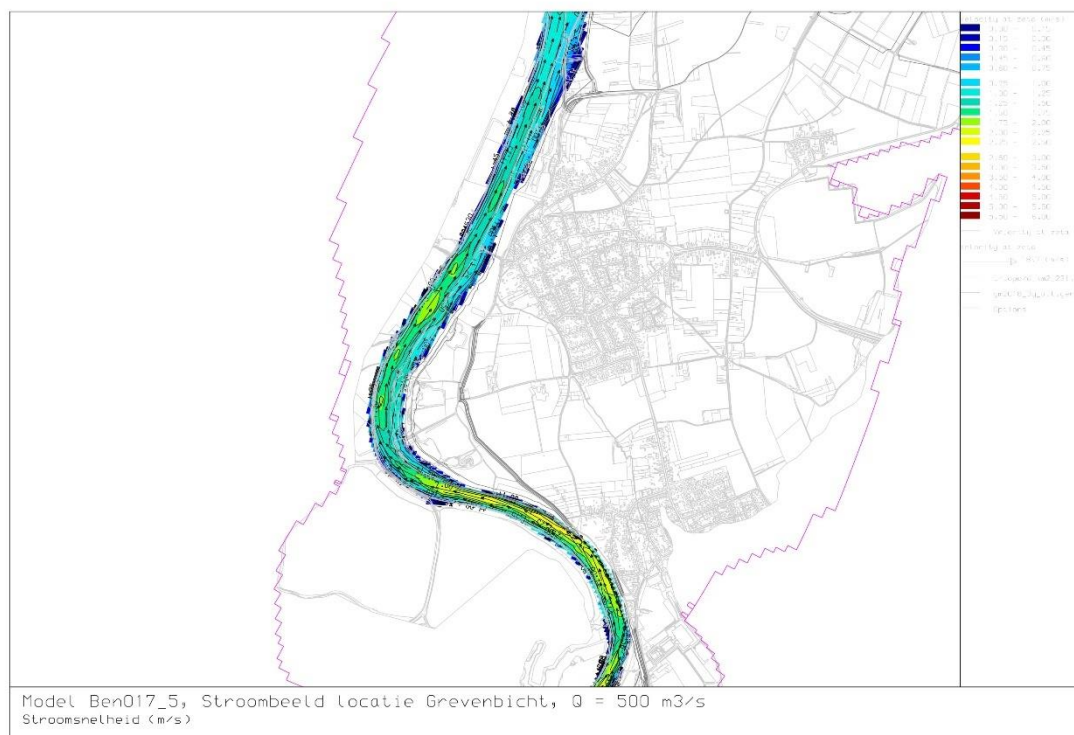
Figuur 4.2c. Stroomsnelheid bij 500 m 3 /s. Voor de legenda zie figuur 4.2a.
