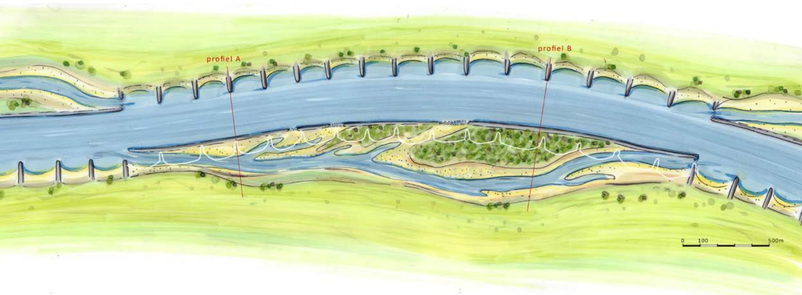
Principeschets meestromende nevengeul met verharde oever langs de Waal. Uitgangspunten zijn het maximaliseren van het ecologisch effect (realisatie KRW-doelen) en het minimaliseren van het effect op de scheepvaart en de hoogwaterveiligheid. Kijk op www.waterpeilen.nl voor de profielen A en B. (Tekening: Stroming, ARK en WNF)
