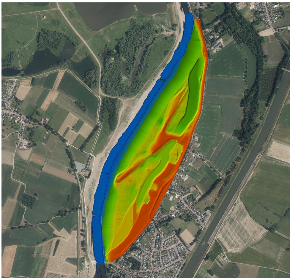
Figuur 1.3. Hoogtekaart van de situatie na uitvoering. In blauw is het gebied aangegeven dat bij 270 m 3 /s is overstroomd. Dit is een smalle strook die van noord naar zuid langs de Maasbedding loopt.
