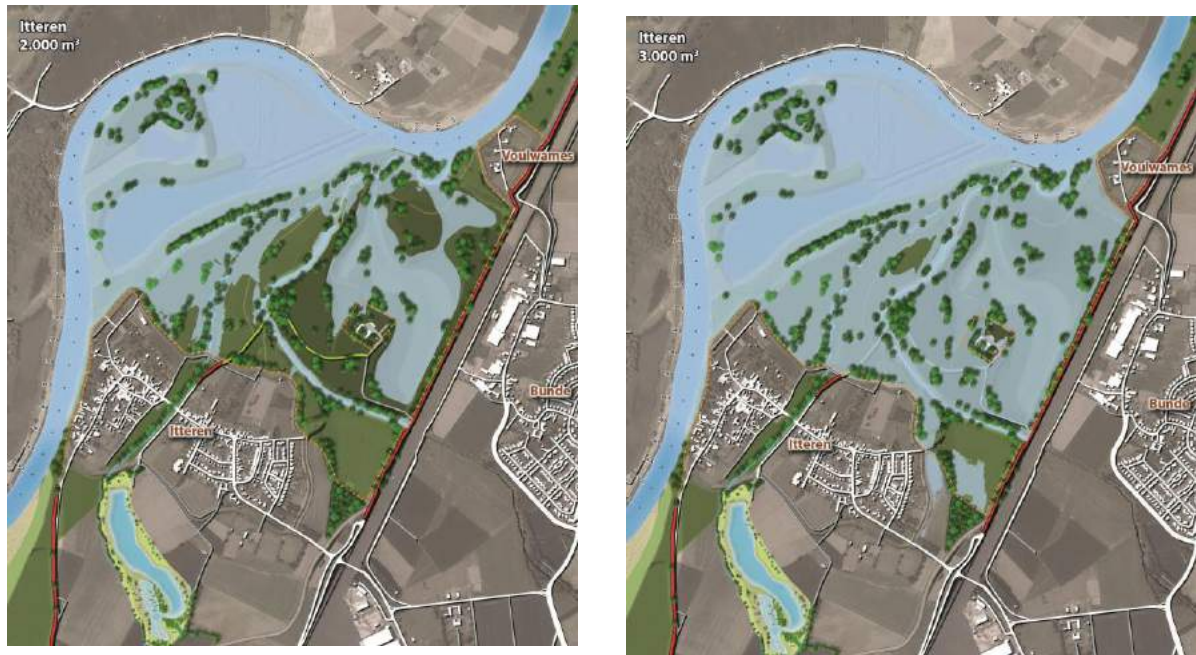
Figuur B1c – inundatie bij 2000 \text{ m}^3/\text{s} en 3000 \text{ m}^3/\text{s} (overschrijding resp. 0,3 dagen per jaar (1x per 5 jaar) en 0,01 dagen per jaar (1x per 125 jaar))
