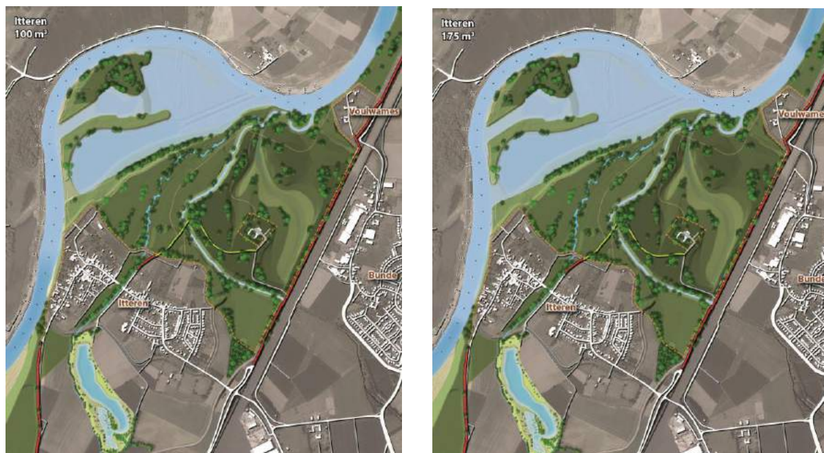
Figuur B1a – inundatie bij 100 m 3 /s en 175 m 3 /s (overschrijding resp. 235 en 205 dagen per jaar)
