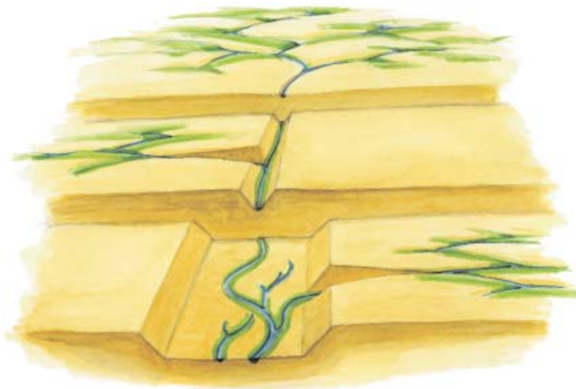
FIGUUR 2.2 De karakteristieke opbouw van een stroomgebied in het middelgebergte: benedenstrooms diep ingesneden dalen met een brede dalvlakte, daarboven diep ingesneden v-vormige dalen en geheel bovenstrooms op de plateaus ondiepe, weidse dalen (de haarvaten).
