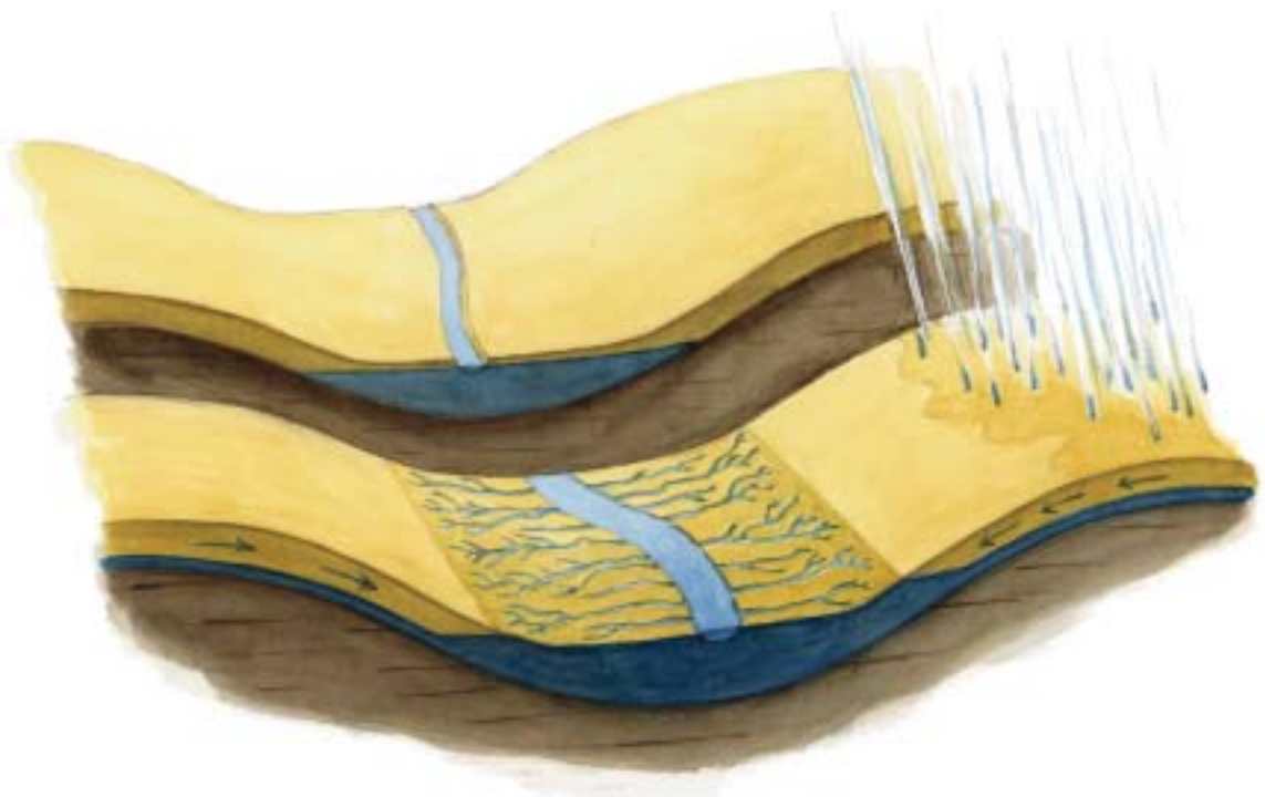
FIGUUR 2.3 Het meeste neerslagwater bereikt de beekdalen door via de bodem ( blauwe pijlen ) af te stromen over de rotsige ondergrond ( grijsbruine ondergrond ). In het dal voedt het een uitgestrekt stelsel van moerasjes, waardoor het water naar de beek stroomt. In de droge situatie ( boven ) droogt deze spons langzaam uit.
