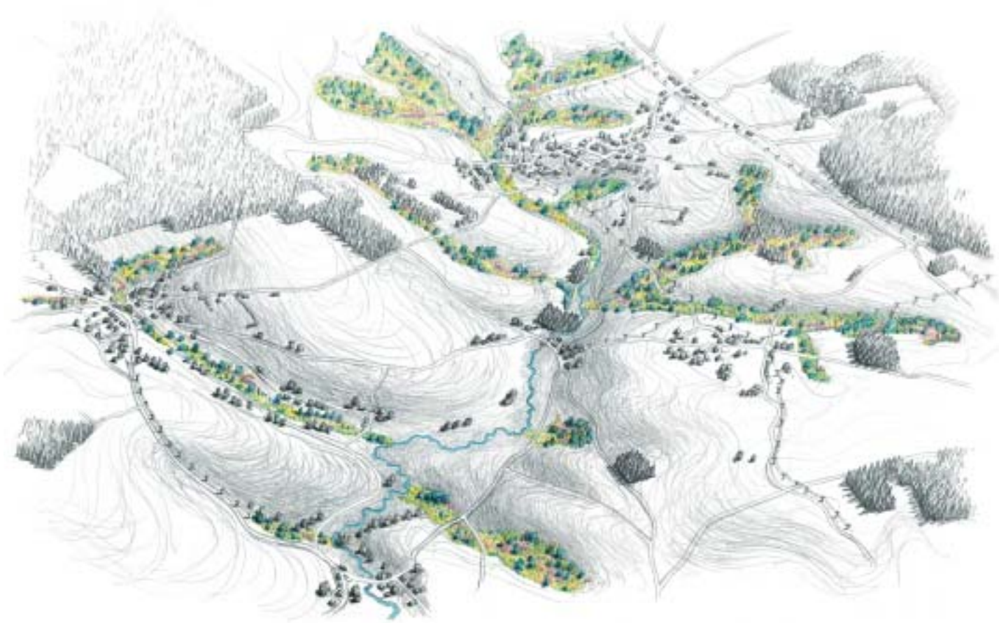
FIGUUR 5.2 Impressie van het bovenstroomse deel van het stroomgebied van de Ourthe, waarbij alle dalvlaktes die geschikt zijn om kwelwater langer op te houden zijn ingericht als doorstroommoeras.
