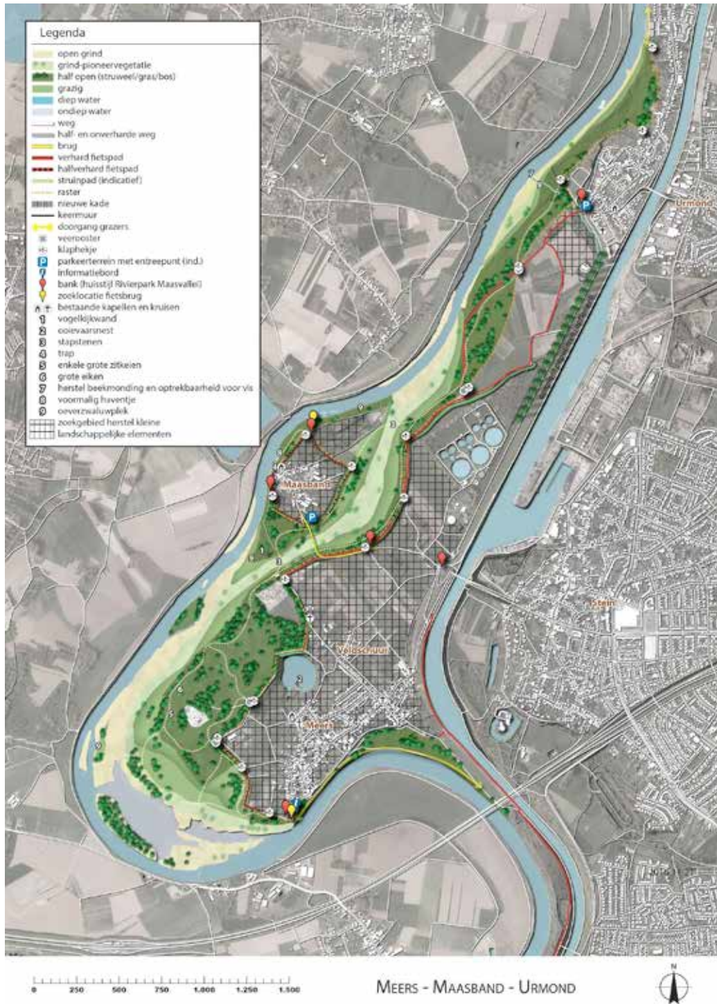
Figuur B1.6. Deeltraject van het Grensmaasproject (Meers-Maasband-Urmond) waar de stroomgeul van de Maas wordt verbreed (geel en lichtgroen) en delen van de hoge oever (donkergroen) worden ingericht als natuurgebied. Dit levert een forse verhoging op van de waterveiligheid en er kan grind worden gewonnen waaruit de kosten van het project worden gefinancierd.
