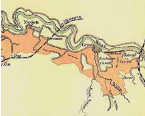
Historische kaart omstreeks 1915 van het stroomgebied van de Raam, met de traverse van de Beerse Maas, waarlangs bij hoge waterstanden op de Maas het Maas- en Raamwater richting het westen werd geleid
