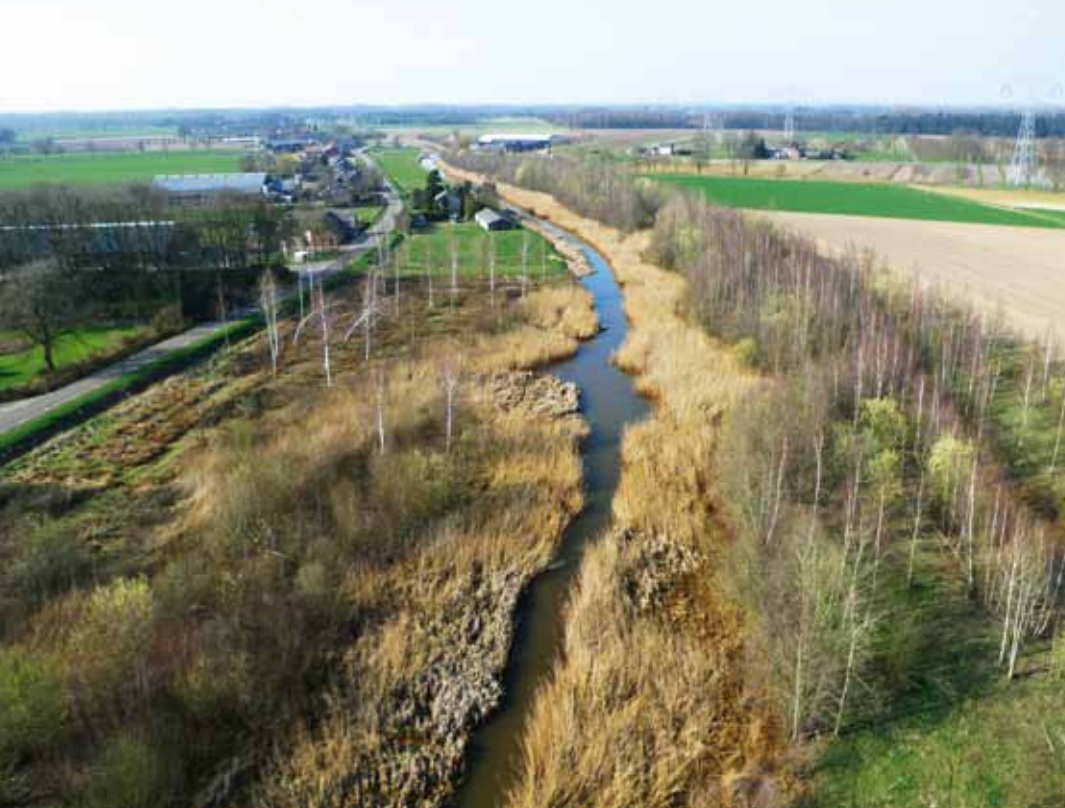
Luchtfoto van de bovenloop van de Graafsche Raam (Lage Raam). Sinds het beheer van de loop in 2005 is gestaakt, is de bedding vanaf de oevers sterk dichtgegroeid; een teken dat de erosieve kracht van het water in de sterk overgedimensioneerde loop zeer gering is.
